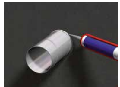
Fuging rundt gjennomføringer
