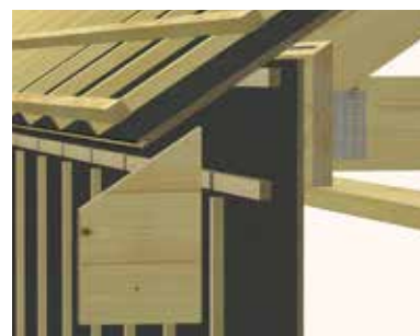
Overgang vegg/tak med løst utstikk
