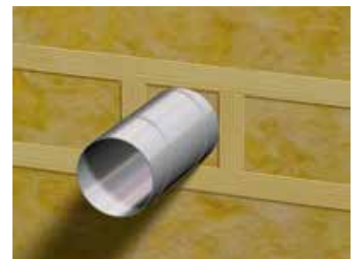
Kubbing rundt gjennomføringer
