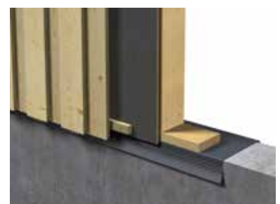
Overgang mur og vegg
