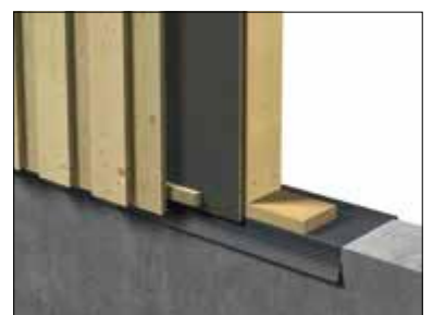
D7. Overgang mur og vegg
