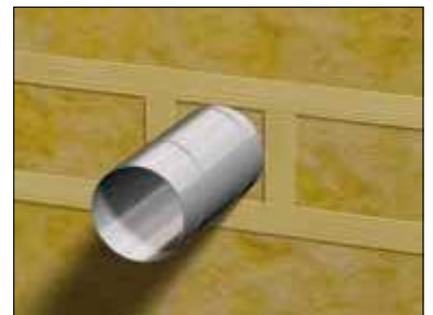
D5. Kubbing rundt gjennomføringer
